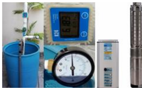
Figura 1. Sistema de bombeo solar.
