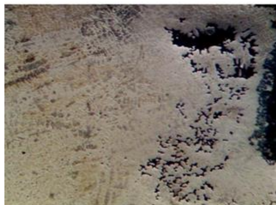
Ilustración 5 - Corrosión intragranular posterior al proceso de reparación
