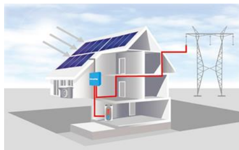
Figura 3 El exceso de electricidad se puede guardar en una batería o devolverse a la red eléctrica pública (ACCIONA, 2019).
