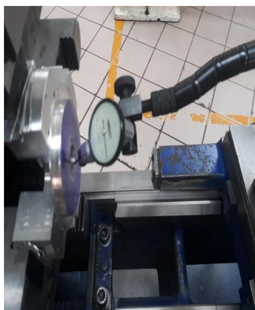
Imagen 2.- Verificación con comparadores analógicos.
