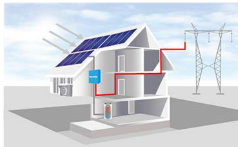
Figura 4 En caso de superar el consumo de energía eléctrica proporcionada por el sistema fotovoltaico se puede tomar directamente de la red pública (ACCIONA, 2019).
