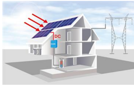
Figura 2 Los paneles solares fotovoltaicos capturan la luz del Sol, provocando que los electrones que hay en las células de silicio liberen energía que se convierte en electricidad como corriente continua (ACCIONA, 2019).
