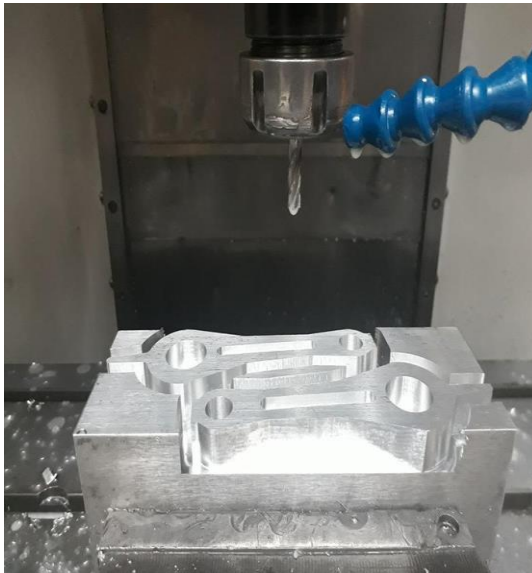
Imagen 3.- Maquinado en control numérico
