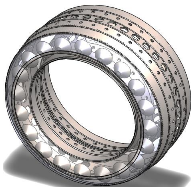
Figura 1. Vista isométrica, diseño de C.C. del motor IAE V2500-A1.
