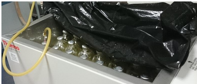
Figura 2. Incubación de los biodigestores en baño María.
