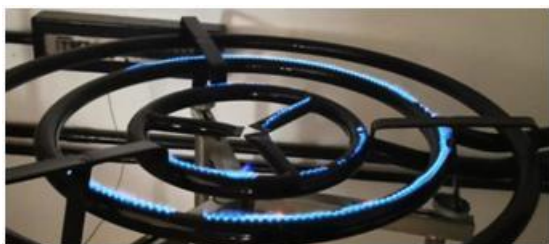
Figura 5. Quemadores sin protección.
