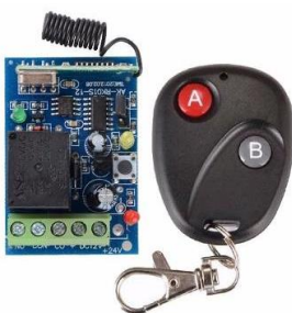
Figura 2. Ilustra un Sistema de control integrado principalmente por, el receptor el control remoto.
