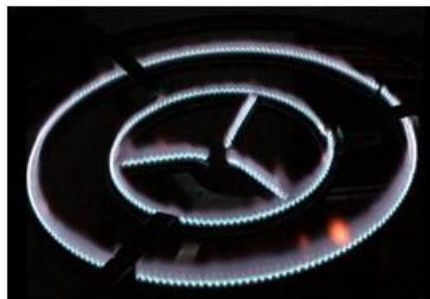
Figura 4(b). Funcionamiento con espreas de diámetro mayor.
