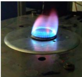
Figura 9. Funcionamiento del quemador con gas L.P.
