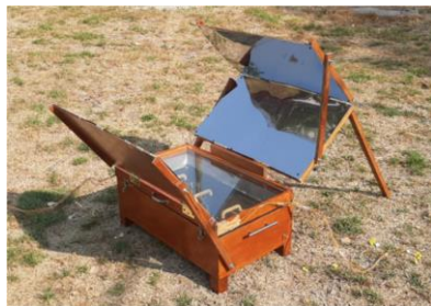
Figura 1. Estufa solar con reflectores externos y almacén térmico de aceite
