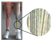
Figura 3. Fabricación de pilones con materiales económicos (bambú). (Shasmin et al., n.d.)
