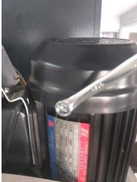
Figura 21. Asa del servo que hay que levantar.
