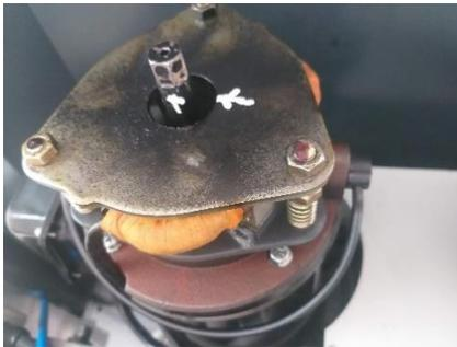
Figura 22. Tornillo del servo que hay que girar.
