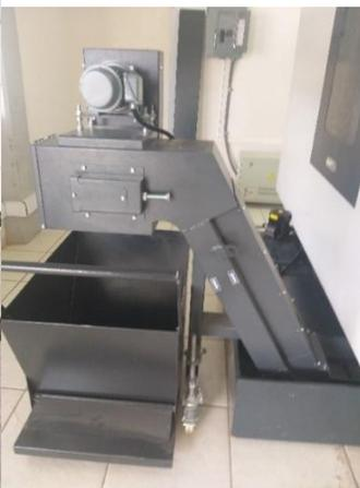
Figura 5. Banda transportadora de rebabas.
