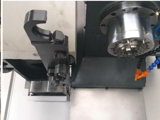
Figura 7. Brazo para cambio de herramientas.
