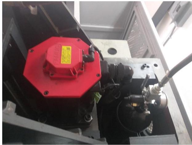
Figura 9. Servomotor eje Z.
