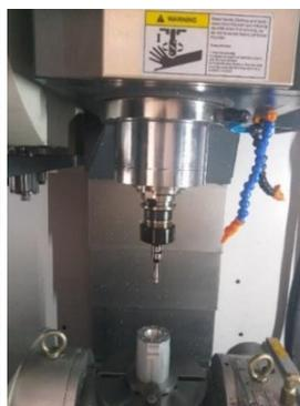
Figura 13. Sensor cero pieza.
