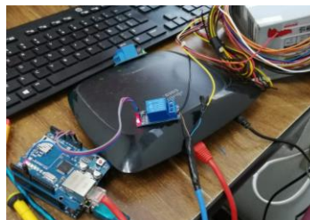
Fig. 5. configuración de Ruteador CISCO, validando las IP disponibles y su puerta de enlace para configuración en el código HTML y Arduino con su tarjeta shield ethernet para su comunicación.
