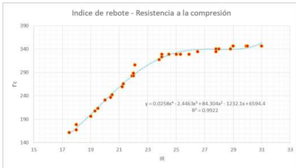
Ilustración 3 Correlación del Índice de rebote y la resistencia a la compresión del concreto
