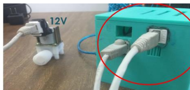
Fig. 10. Prueba de conectividad y alimentación con válvula solenoide de 12V.
