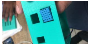
Fig. 9. Prueba de conectividad y alimentación sensor de Temperatura y humedad de 5v.
