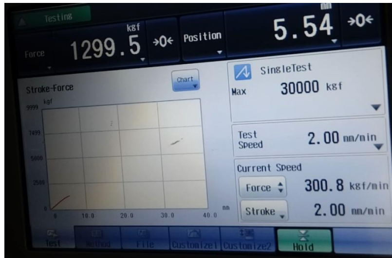
Figura 15 - Esfuerzo-Deformación (deformación 5.54mm y carga 1299kgf)
