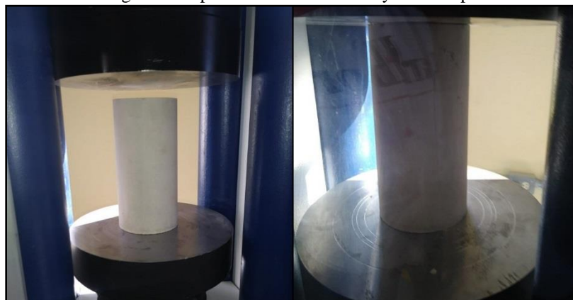
Figura 7. Probetas durante el ensayo de compresión uniaxial.
