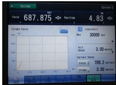
Figura 4 esfuerzo-deformación (carga 687.875 kgf y deformación 4.83mm).
