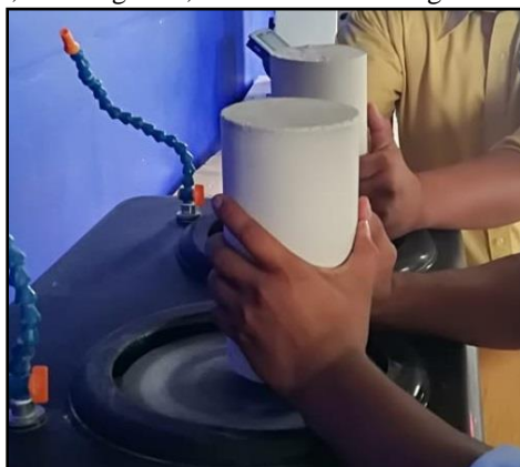
Figura 5. Desbaste de las caras de las probetas.
