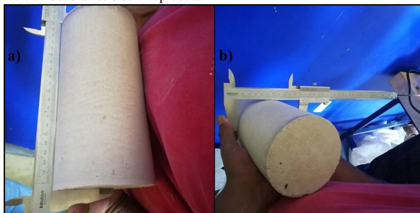
Figura 6. Medición de una probeta; a) Medición de la altura; b) Medición del diámetro.
