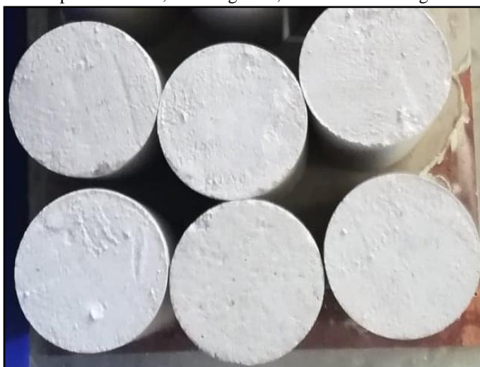
Figura 4. Probetas fraguadas después de 28 días.
