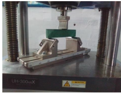
Figura 11. probeta instalada en la maquina Universal SHIMADZU
