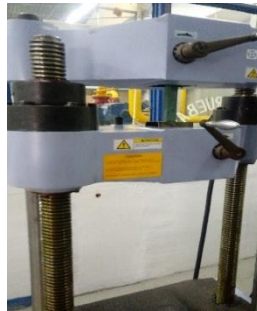
Figura 2. probeta instalada en laMaquina universal de ensayos SHIMADZU
