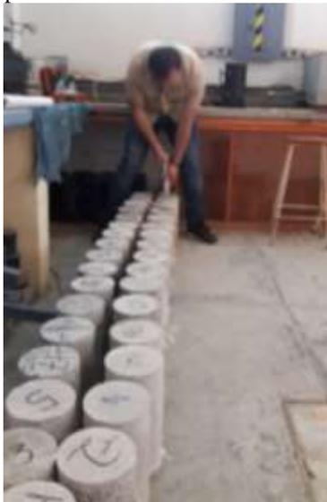
**Ilustración 1 Aplicación del esclerómetro**
