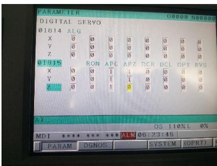
Figura 17. Parámetro APZ= 0 para establecer el cero del eje X, Y o Z.
