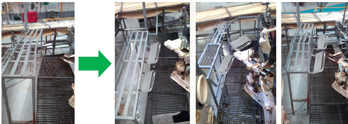
Figura 7. Vista actual del puesto de trabajo –vista con asiento abatible del puesto de trabajo
