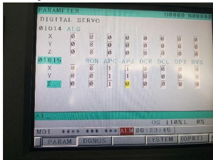
Figura 19. Parámetro 1015 APZ=0 para dar la referencia de casa.
