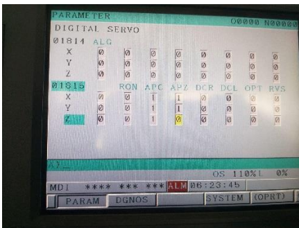
Figura 16. Parámetro 1015 para liberar ejes o establecer nueva referencia de casa.
