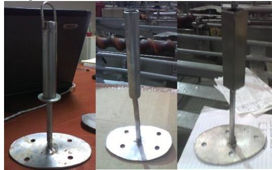
Figura 6. Aplastador actual para realizar la actividad de acomodo de sardina
