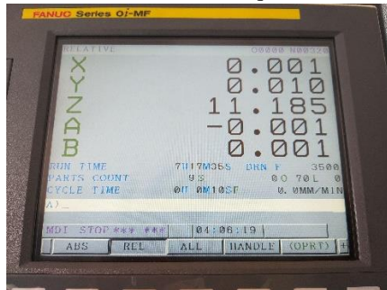
Figura 18. Distancia de Z donde se mueve el eje Z para hacer el cambio de herramienta.
