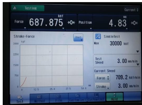
Figura 4 esfuerzo-deformación (carga 687.875 kgf y deformación 4.83mm).
