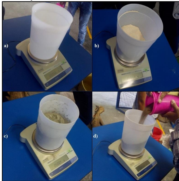
Figura 1. Pesado de los componentes de la mezcla: a) Agua; b) Polvo de mármol; c) Cemento; d) Arena.
