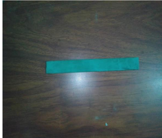
Figura 1. probeta del material necuron 1001 para el ensaye de Tension
