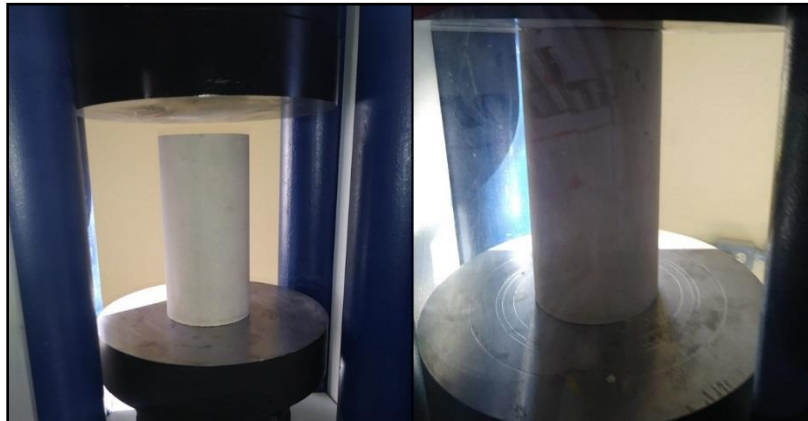
Figura 7. Probetas durante el ensayo de compresión uniaxial.
