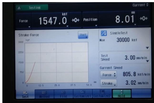
Figura 5. esfuerzo-deformación (carga 1547kgf y deformación 8.01mm)
