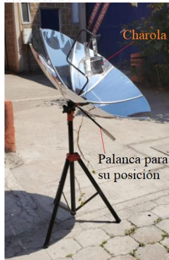
Figura 1. Estufa solar con reflectores externos.
