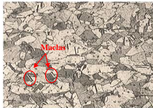
Figura 2. Microestructura del acero 316 L testigo, a 100 x, atacada con gliceregia por 45 segundos.
