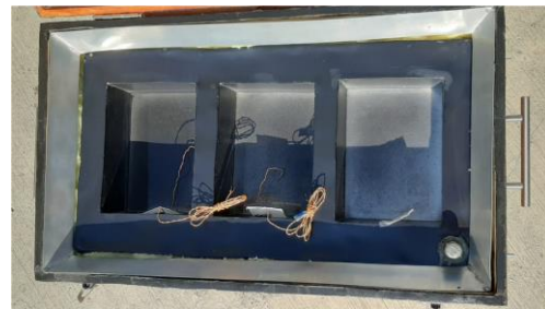
Figura 2. Vista al interior de la estufa solar, se aprecia el almacén térmico y las 3 charolas para colocar alimentos.
