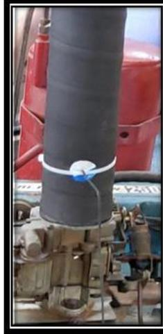
Figura 2. Termopar en la admisión.
