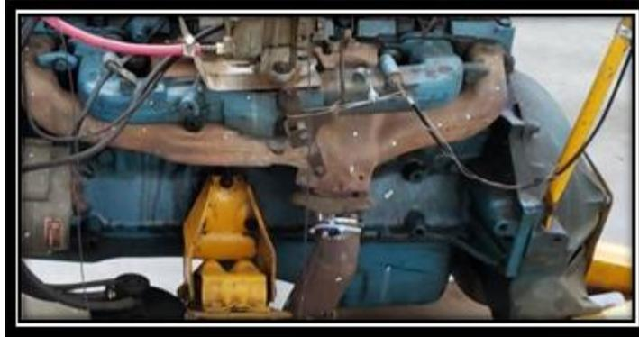
Figura 4. Termopar en el escape.
