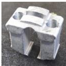
Figura 1. Retractor Shoe maquinada
