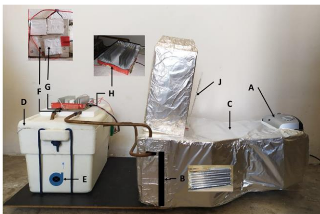
Figura 1. Modelo Experimental del cosechador para la Generación de Potencia Eléctrica.
