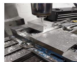
Figura 12. Acabado del fixture
