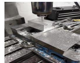
Figura 12. Acabado del fixture
