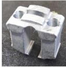
Figura 1. Retractor Shoe maquinada
