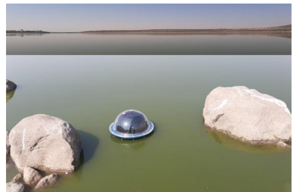
Figura 6: Prueba de funcionamiento del sistema Data Logger en presa de Santa Catarina Querétaro, Qro.
