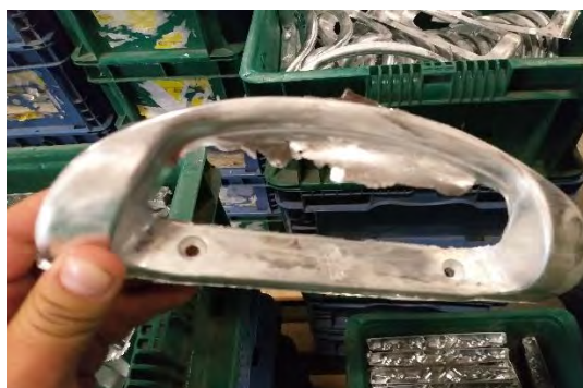
Figura 1 Pieza moldeada con exceso de material o rebaba en línea de separación
