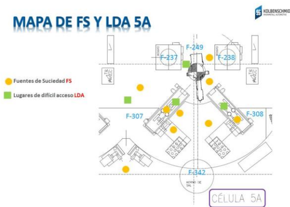
Figura 1 Mapa de Fuentes de Suciedad y Lugares de Difícil Acceso de la célula.
