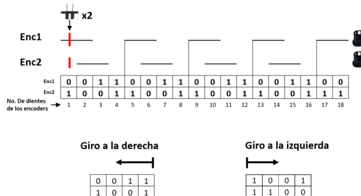
Figura 2. Tren de pulsos de encoder con la lógica de giro derecha-izquierda.
