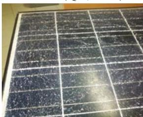
Figura 4. Módulo fotovoltaico presentando rupturas del vidrio
