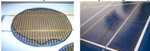
Figura 3. Módulo fotovoltaico con células decoloradas
