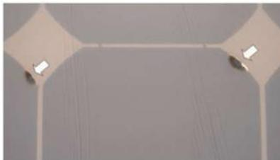
Figura 5. Módulo que presenta puntos calientes sobre los bordes de las esquinas superiores
