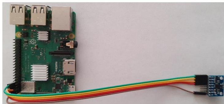
Figura 7 Conexión entre Raspberry Pi y GY-521
