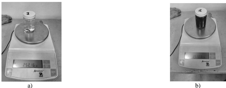
Figura 3. a) Peso de frasco con tapón + agua destilada, b) Frasco con tapón + agua + fibra
