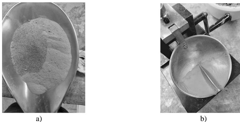
Figura 1. a) Muestra de arena y arcilla, b) Enrasadura de una de las determinaciones
