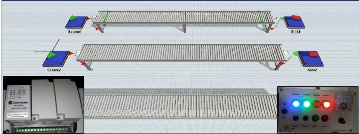
Figura 3. Modelo en FlexSim y sistema de control con PLC.
