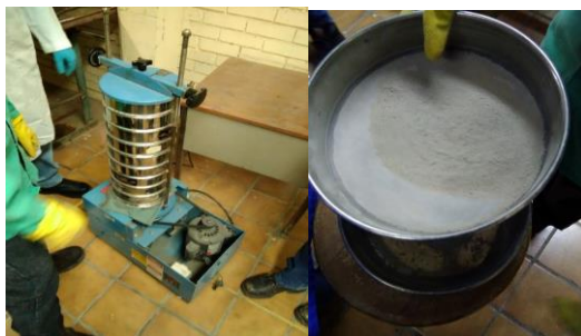
Figura 2. Tamiz ROTAP y mineral cribado
