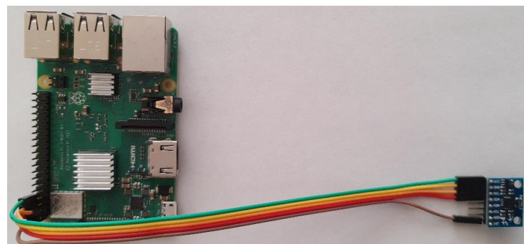
Figura 7 Conexión entre Raspberry Pi y GY-521
