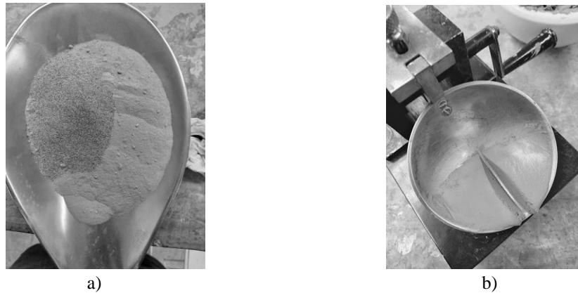
Figura 1. a) Muestra de arena y arcilla, b) Enrrasadura de una de las determinaciones
