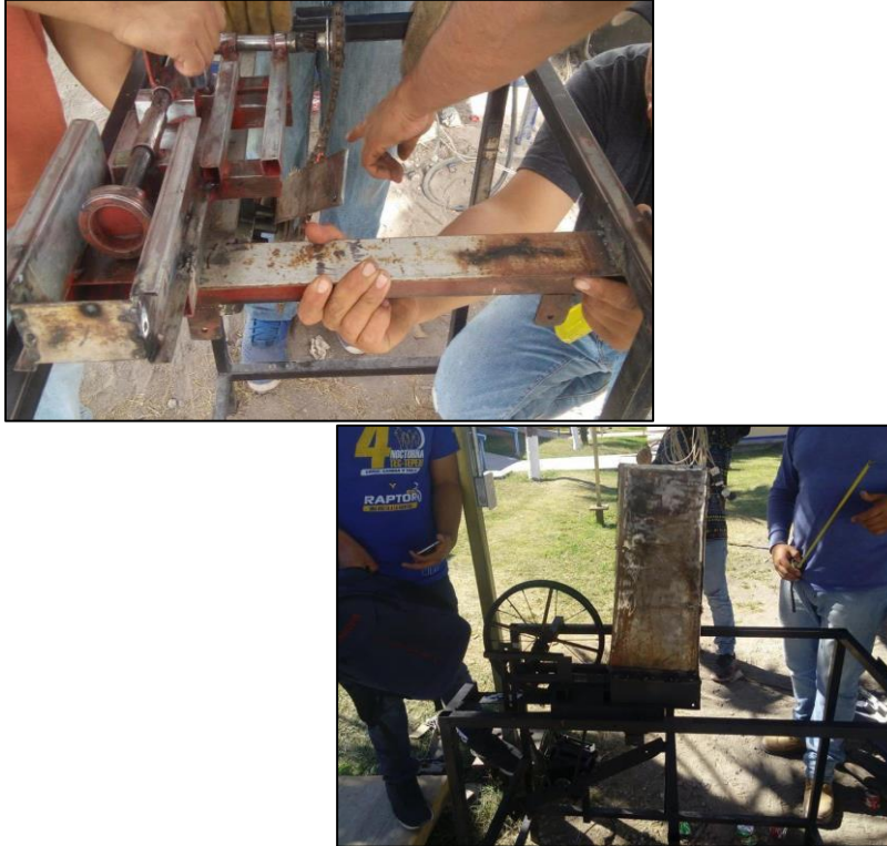
Figura 7. Diseño del mecanismo de excitación y del prototipo didáctico de vibraciones
