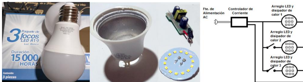
Figura 2. Izquierda, lámpara LED de 10W de potencia. Centro, Componentes principales de la lámpara. Derecha, diagrama electrónico para las modificaciones de la luminaria.
