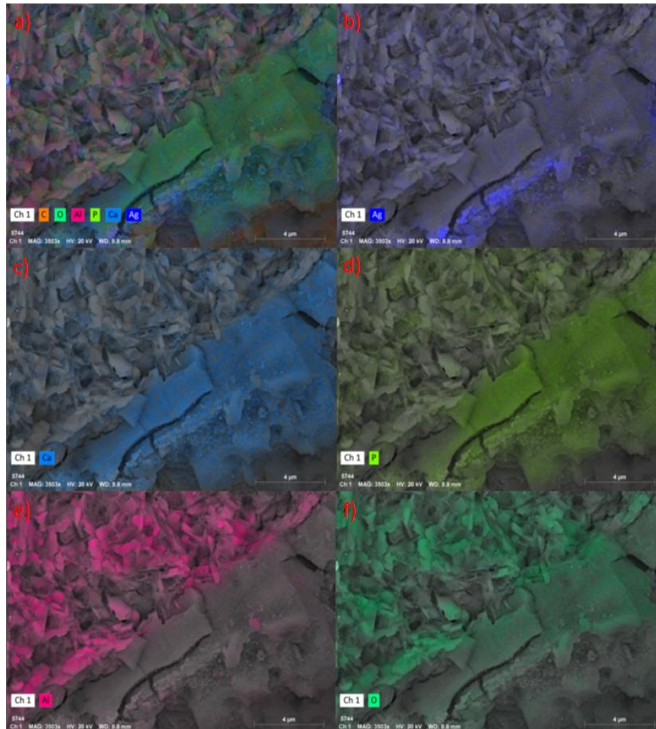
Figura 2. Análisis composicional de alúmina-HA-NpsAg por MEB, a) carbono, oxígeno, fósforo, calcio, carbono y plata, b) plata, c) calcio, d) fósforo, e) aluminio y f) oxígeno.
