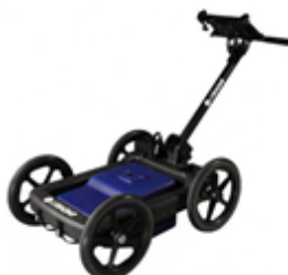
Figura 1. Georadar utilizado en la adquisición de datos. Es un GPR US Radar Modelo Q25C Geophysical Radar System 250 MHz
