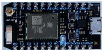
Figura 4. Tarjeta de desarrollo Particle Photon
