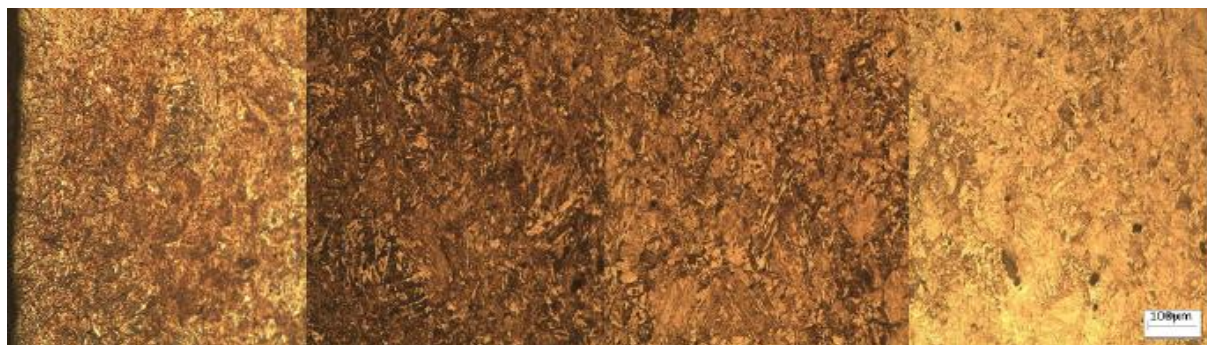
Figura 6. Micrografía de Capa carburada, zona de transición y núcleo. Cementación a 890°C por 10 horas a 10X.
