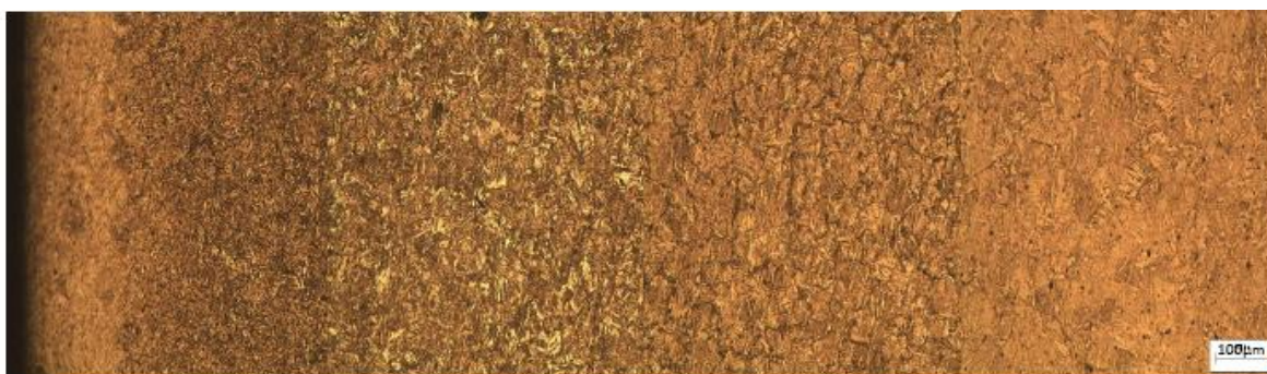
Figura 3. Micrografía de Capa carburada, zona de transición y núcleo. Cementacion a 890°C por 4 horas a 10X.
