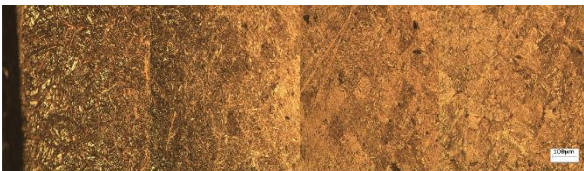
Figura 10. Micrografía de Capa carburada, zona de transición y núcleo. Cementación a 950°C por 10 horas a 10X.
