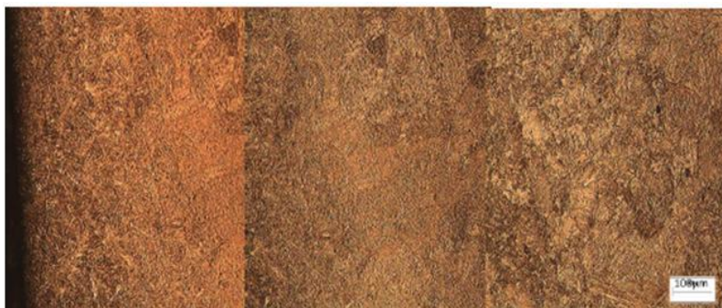
Figura 7. Micrografía de Capa carburada, zona de transición y núcleo. Cementación a 950°C por 4 horas a 10X
