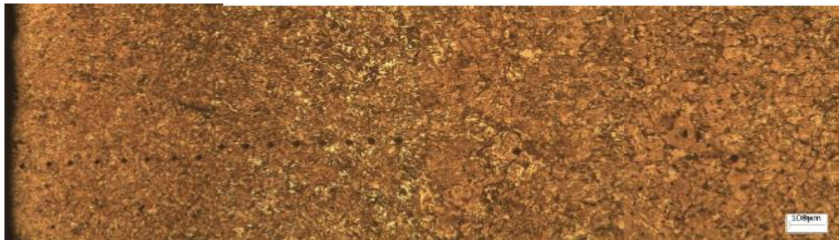
Figura 5. Micrografía de Capa carburada, zona de transición y núcleo. Cementación a 890°C por 8 horas a 10X.
