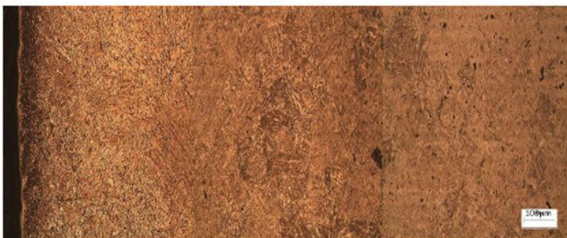
Figura 7. Micrografía de Capa carburada, zona de transición y núcleo. Cementación a 950°C por 4 horas a 10X
