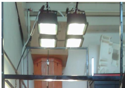
Figura 3. Simulador solar integrado por lamparas infrarrojas
