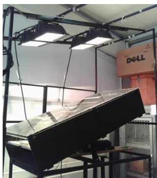
Figura 4. Acoplamiento del secador y simulador solar.
