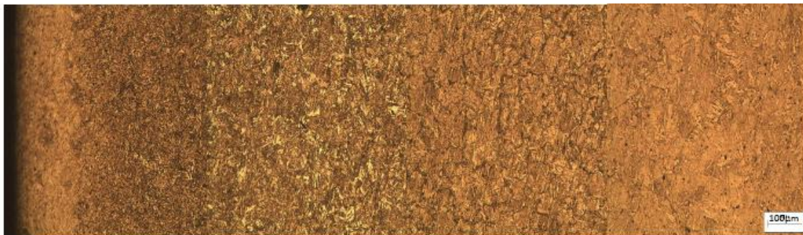
Figura 3. Micrografía de Capa carburada, zona de transición y núcleo. Cementación a 890°C por 4 horas a 10X.
