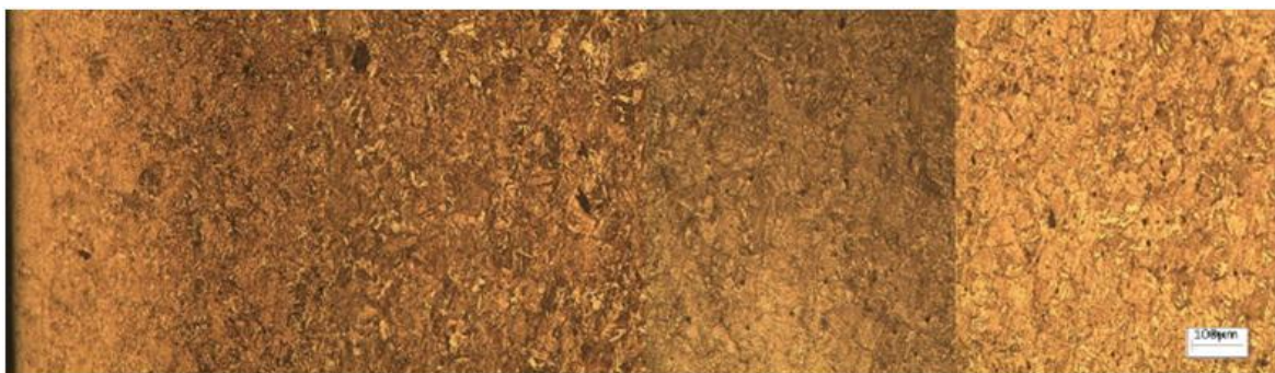
Figura 4. Micrografía de Capa carburada, zona de transición y núcleo. Cementación a 890°C por 6 horas a 10X.
