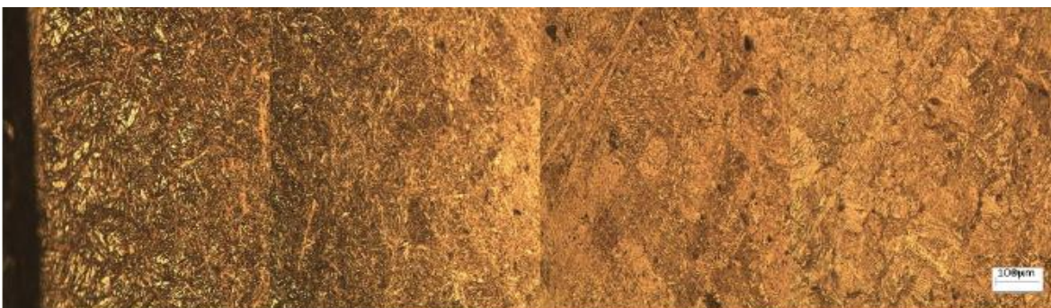
Figura 10. Micrografía de Capa carburada, zona de transición y núcleo. Cementación a 950°C por 10 horas a 10X.
