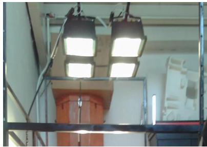
Figura 3. Simulador solar integrado por lámparas infrarrojas
