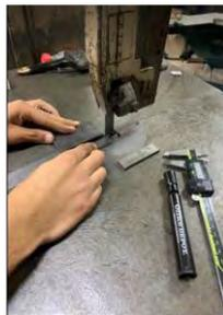
Figura 2. Corte de material en sierra de cinta
