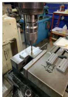
Figura 4. Barrenado en fresadora convencional
