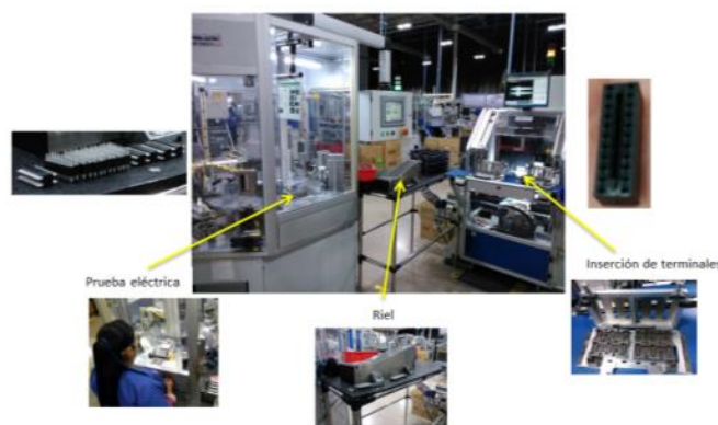
Figura 1. Estación Jumper Kimball Nexter. Fuente: elaboración propia.
