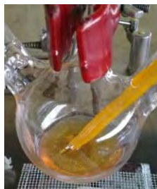
Fig. 3. Condensación del poliéster (Villaseca Alonso, 2019)
