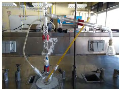
Figura 1. Montaje del equipo para la oxidación de aldehídos (Villaseca Alonso 2020)
