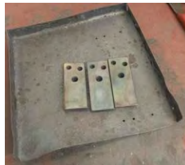
Figura 6. Piezas una vez templadas y revenidas °C
