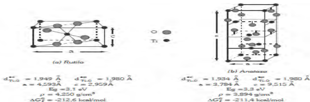
Figura 1. Celdas unitarias de (a) rutilo y (b) anatasa. El titanio ocupa una posición central del octaedro TiO_6 . Tuesta E. G., et al (2004).
