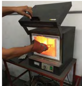
Figura 5. Piezas en el horno a 950 °C
