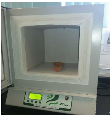
Figura 3. Muestra de talavera dentro de la mufla para la prueba
