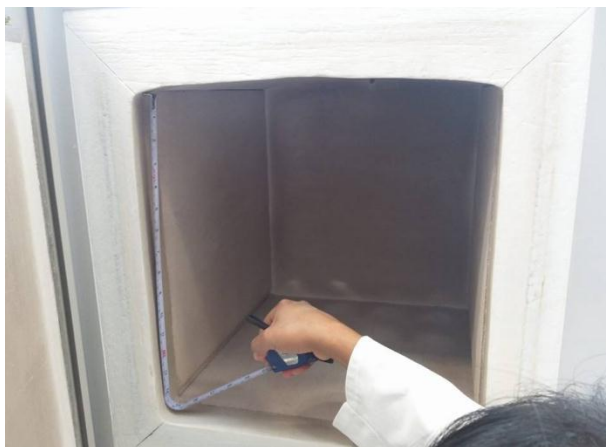
Figura 2. Medición de dimensiones interiores de la mufla
