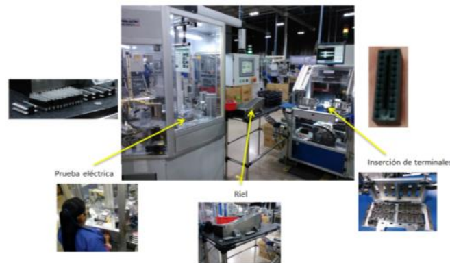
Figura 1. Estación Jumper Kimball Nexter. Fuente: elaboración propia.
