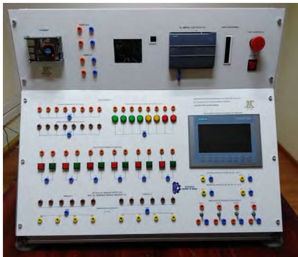
Figura 3 Prototipo físico del entrenador de redes industriales
