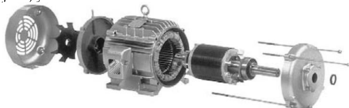
Figura 5. Vista despiezada del motor de jaula de ardilla, que muestra el estator, el rotor, las tapas laterales, el ventilador de enfriamiento, los cojinetes de bolas y la caja de terminales.
