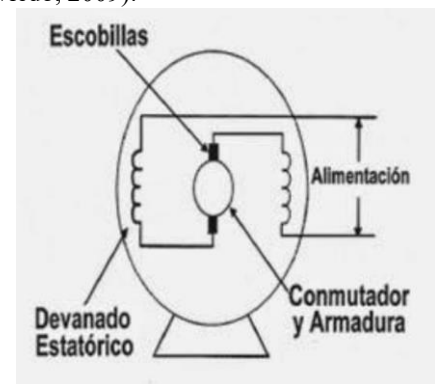
Figura 4. Conexión de devanados del motor universal. (simbología americana).
