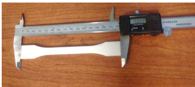
Figura 5 – Verificación de probetas.
