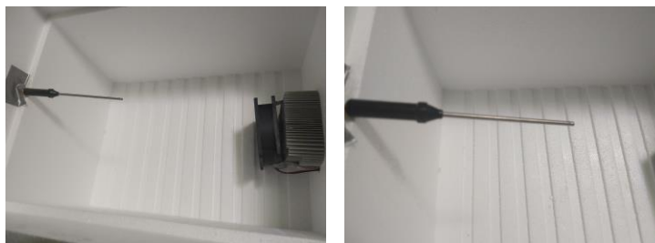
Figura 2 Colocación del sensor de temperatura sobre el recipiente
