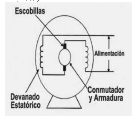
Figura 4. Conexión de devanados del motor universal. (simbología americana).
