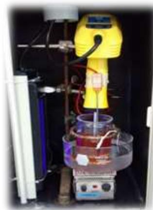
**Figura 4. Reactor Fotocatálisis-Sonólisis**
