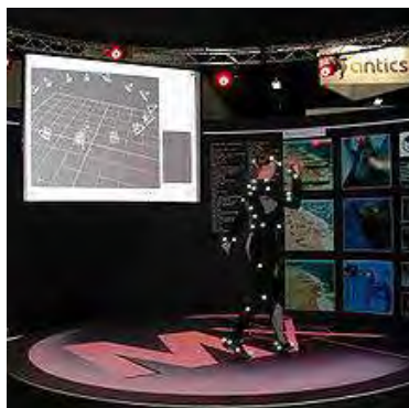
Figura. 1. Sistema de captura de movimiento (avatar)
