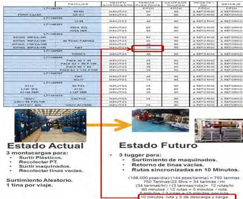
Figura 5. Cálculo de Takt-Time, Pitch- Time y definición de rutas y sus tiempos.
