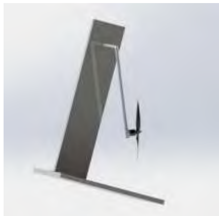
Figura 3. Diseño del Aeropéndulo en SolidWorks
