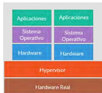
**Figura 2. Infraestructura Hypervisor Asistido por Hardware**
