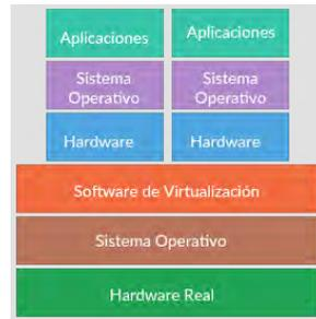
**Figura 3. Infraestructura Hypervisor Asistido por Sistema Operativo**
