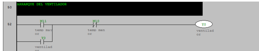
Figura. Control de paro y arranque del ventilador.
