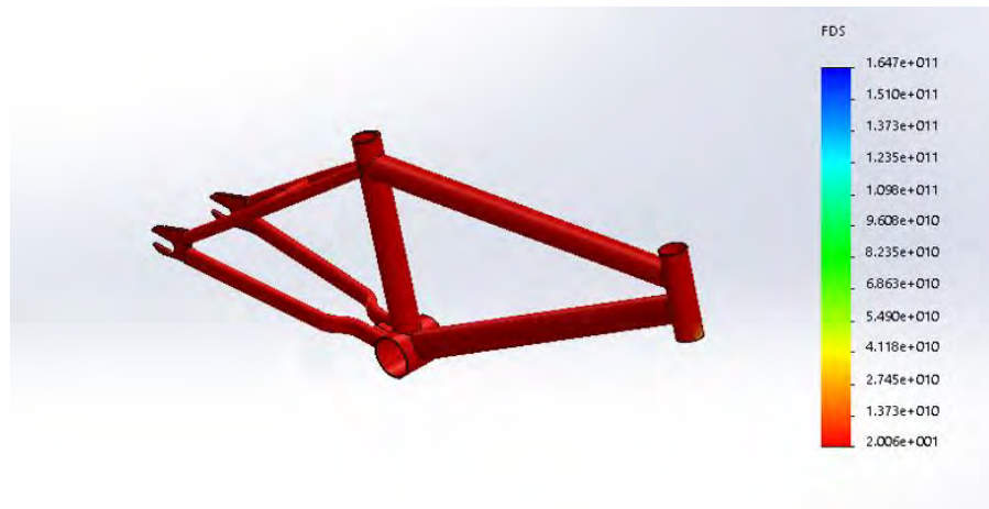
Figura 6. Factor de seguridad del marco para bicicleta
