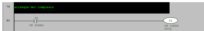
Figura. Activación del compresor.
