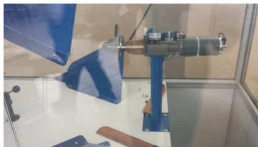
Figura 2. Aerogenerador instalado en el túnel de viento Astriane.
