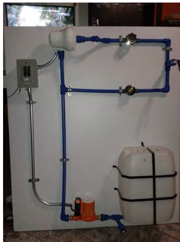
Figura 6 Simulación de regadera para montaje de Dispositivo
