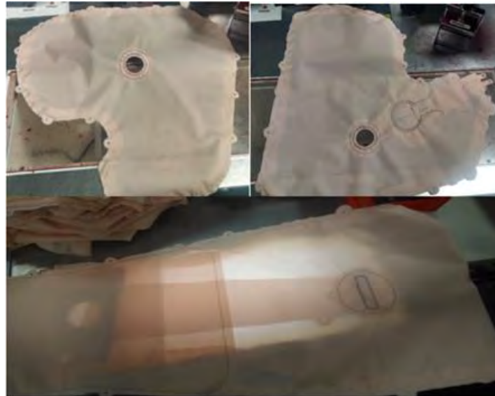
Figura 1. Paneles laterales y panel principal de una bolsa de aire.
