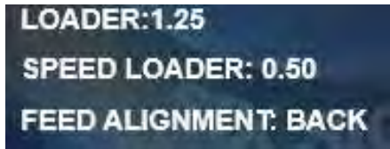
Figura 13 Parámetros óptimos de la maquina
