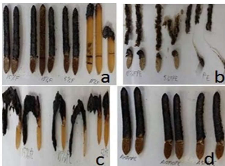
Figura 4. Probetas del ensayo de inflamabilidad: a) AC, b) PC, c) AP, d) APC.
