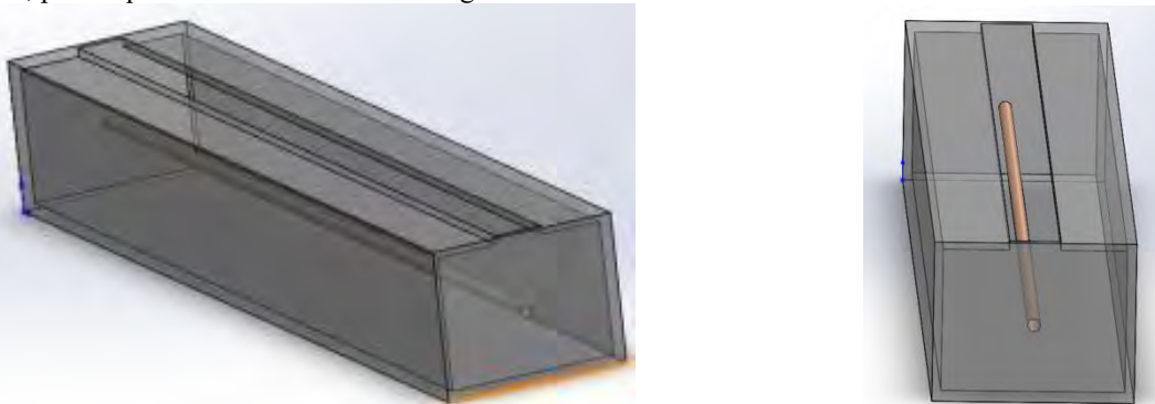
Figura 3: Diseño de la base del robot que permite un movimiento horizontal sobre el eje x al transformar el movimiento circular del tornillo sin fin en un movimiento lineal.
