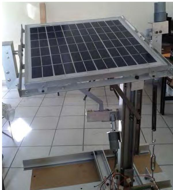
Figura 7. Prototipo del Seguidor Solar
