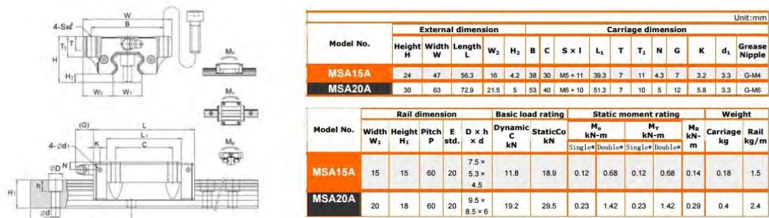
Figura 12. Características de sistema de deslizamiento tipo guía lineal cuadrada
