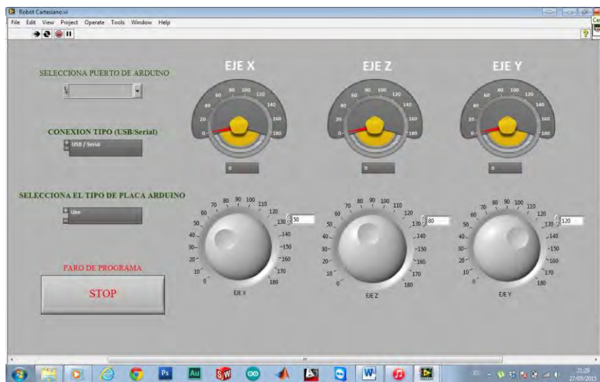
Fig. 9. Panel Frontal para manipulación de servomotores desde LabVIEW.
