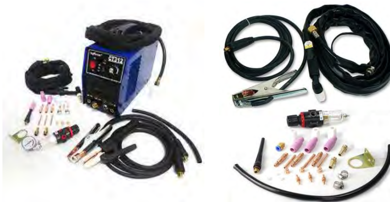
Figura 4. Equipo típico de corte de plasma Descripción del método
