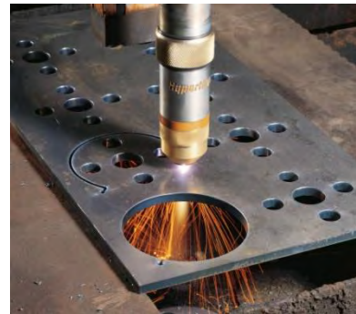
Figura 3. Detalle del corte del plasma en placa
