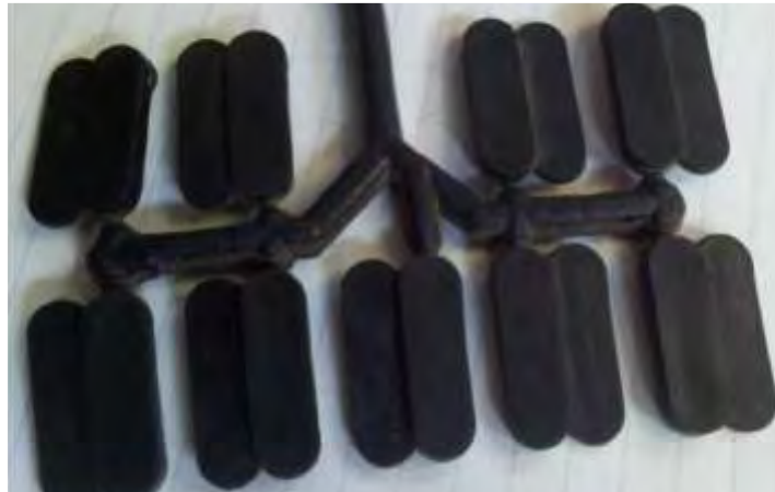
Figura 1. Herrajes plásticos para vidrio mediante inyección.
