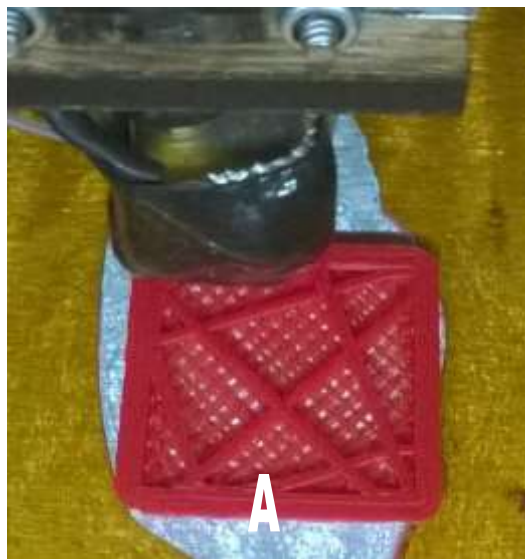
Figura 7. Capas superpuestas, necesarias para fabricar una pieza mediante impresión 3D, uno como usuario tiene la ventaja de configurar el patrón de relleno (A) para aumentar o disminuir la dureza de la pieza.
