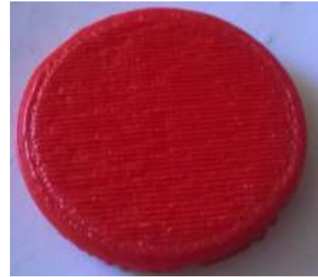
Figura 9. Figura con espesor de capa mayor
