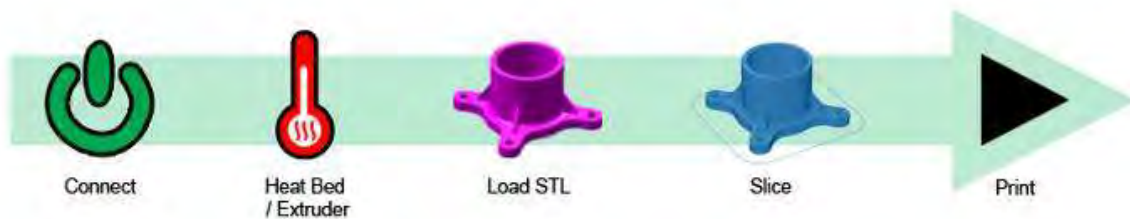
Figura 5. Proceso que sigue una impresora 3D para fabricar un objeto en ABS
