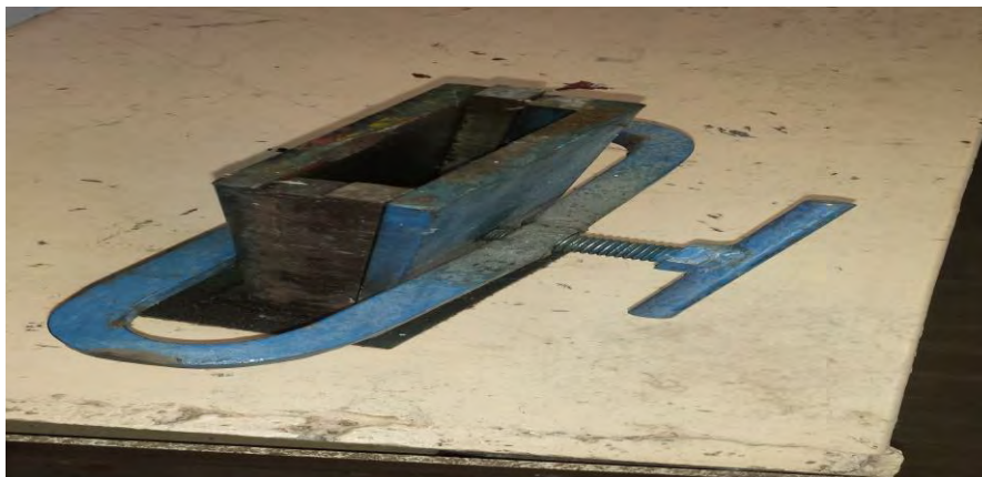
Figura 1. Esta es el molde permanente o chaponera para el vaciado.
