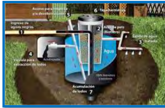
Figura 2. Diagrama de operación del Biodigestor Anaerobio. (Rotoplas).
