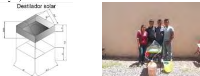
Figura 1. Dibujo y fotografía del prototipo del destilador solar. Creación propia.
