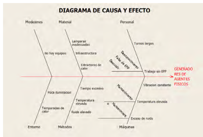
Fig. 1.- Diagrama Ishikawa para identificar la identificación de factores físicos.
