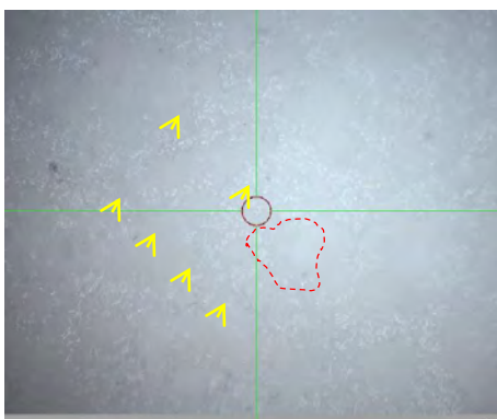
Figura 1.- Aspecto de la pastilla M5 en la que se observa dos fases una correspondiente a la formación de cristales y una segunda fase de mayor proporción blanca y lisa”.
