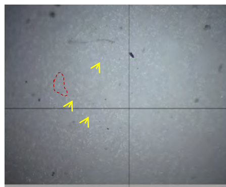
Figura 2.- Aspecto de la pastilla M8 en la que se observa dos fases una correspondiente a la formación de cristales y una segunda fase de mayor proporción blanca y lisa”.
