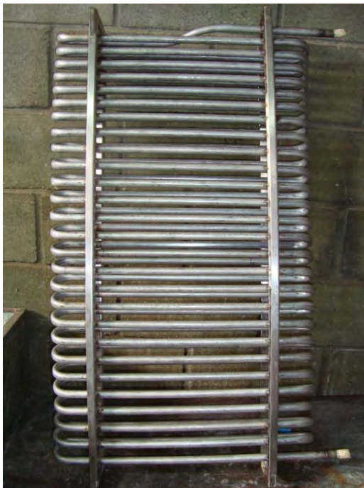
Figura 6. Fabricación del evaporador en material de acero inoxidable.
