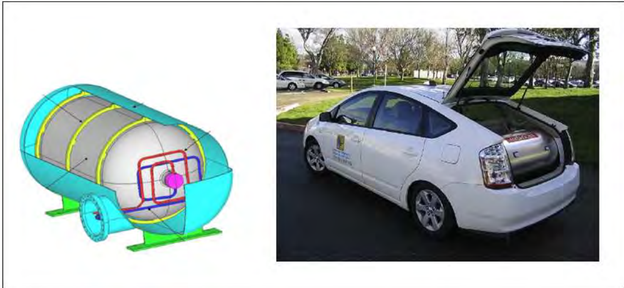
Figura 3. Recipiente criogénico de hidrógeno montado en un automóvil para pruebas experimentales de manejo.
